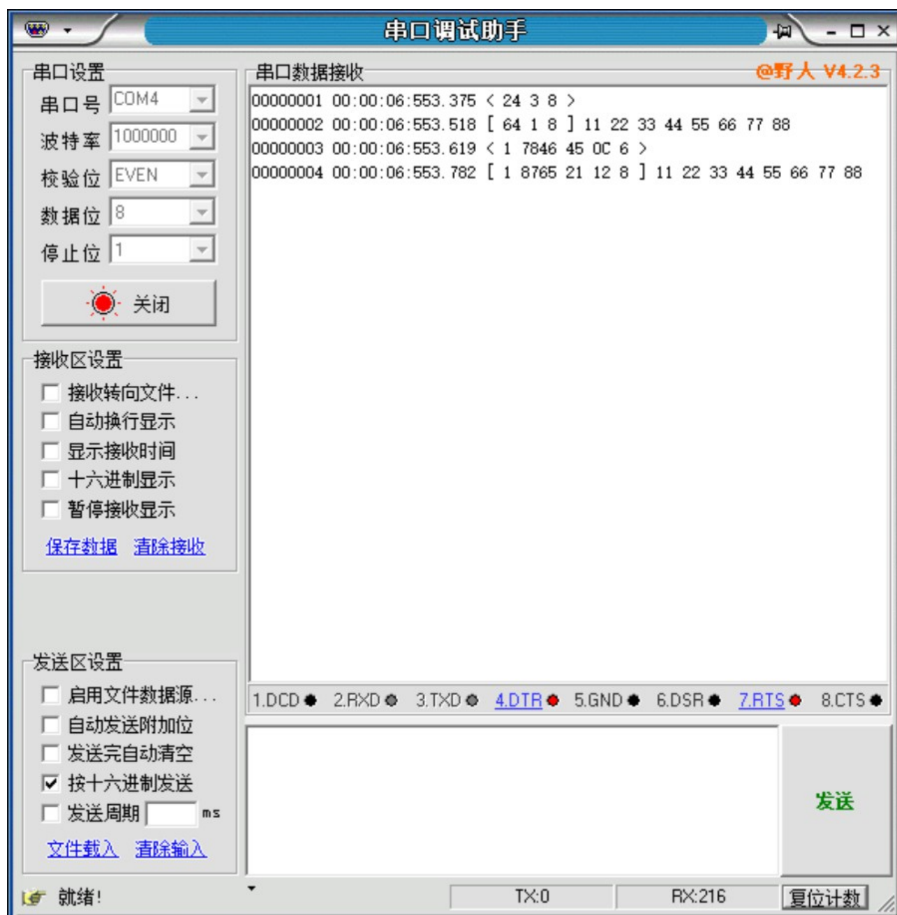
图 11 TTCANopen 调试模块接收显示举例
