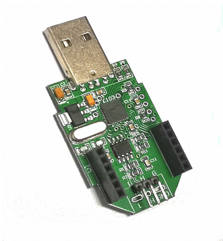
图 10 CANFD 转 SPI 接口
