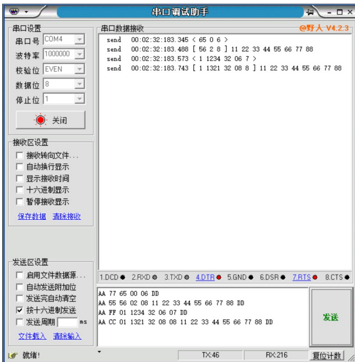
图 12 TTCANopen 调试模块发送指令和回显示例
