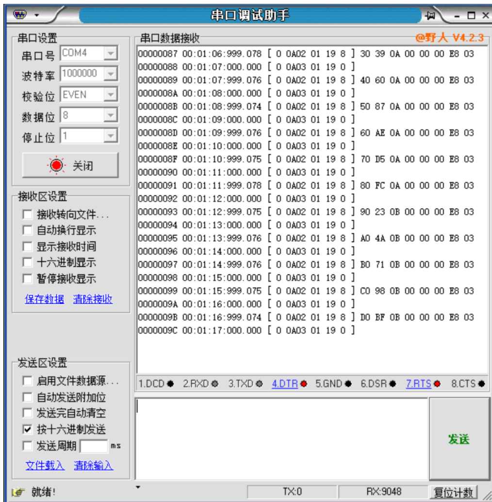
图 14 TTCANopen 调试模块与系统时间同步
