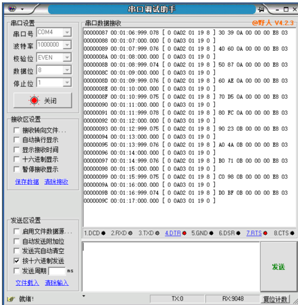
图 14 TTCANopen 调试模块与系统时间同步
